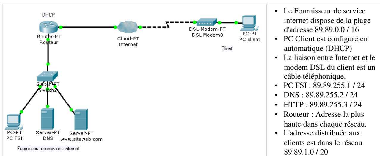
Ajoutez aux routeurs les modules nécessaires. Activez toutes les interfaces utilisées. Tous les paramétrages des routeurs devront être effectués par l'interface de commandes en ligne (Cliquez sur le routeur puis utilisez l'onglet CLI).
