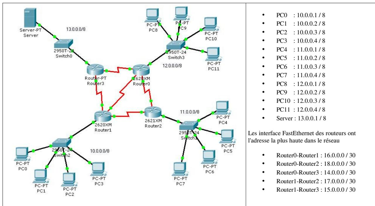
Ajoutez aux routeurs les modules nécessaires. Activez toutes les interfaces utilisées. Tous les paramétrages des routeurs devront être effectués par l'interface de commandes en ligne (Cliquez sur le routeur puis utilisez l'onglet CLI).
