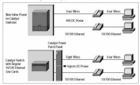
Si vous n'avez pas un switch qui assure la téléalimentation (POE : Power Over Ethernet) ou un power patch panel, il est obligatoire de disposer d'un transformateur externe par téléphone Ip (IP-PHONE). Il est à noter qu'en cas de panne secteur, il n'y a plus de téléphone ( c'est normal ) et aucun appel d'urgences n'est donc possible.
