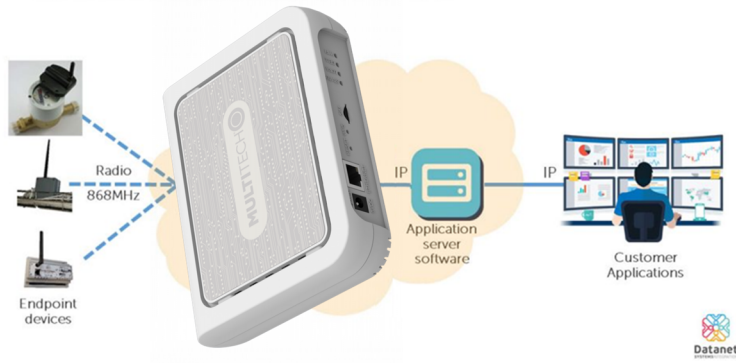
Figure 12 – Passerelle Multitech au coeur du réseau
