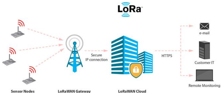
Figure 7 – Structure d'un réseau LoRaWAN
